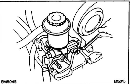
9. REMOVE PS DRIVE BELT AND PUMP PULLEY
