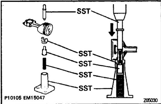
**3. DISCONNECT CONNECTING ROD FROM PISTON**
