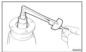
(d) Using a torque wrench, measure the preload.
