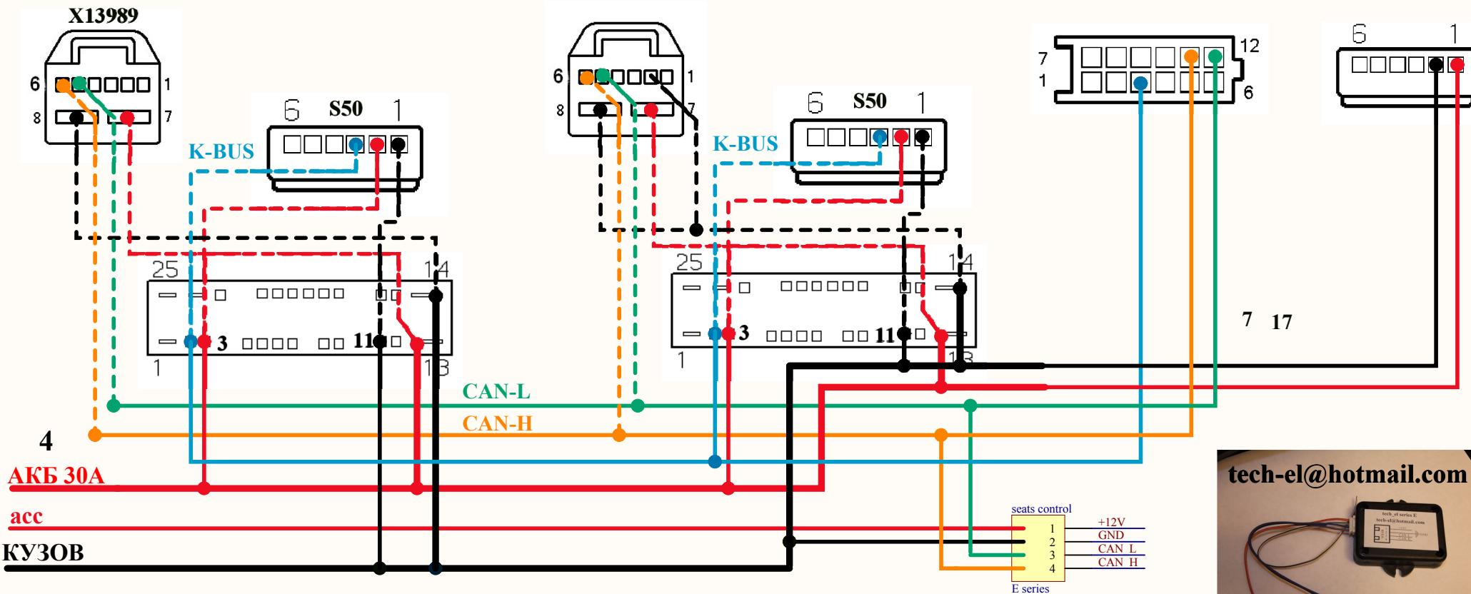
подключение сидений BMW 5 E60 series вариант использования штатных кнопок
