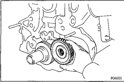
**14. REMOVE OIL PUMP DRIVE SHAFT GEAR**
