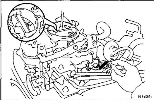
**11. INSPECT AUXILIARY ACCELERATIONS PUMP (AAP) SYSTEM**
