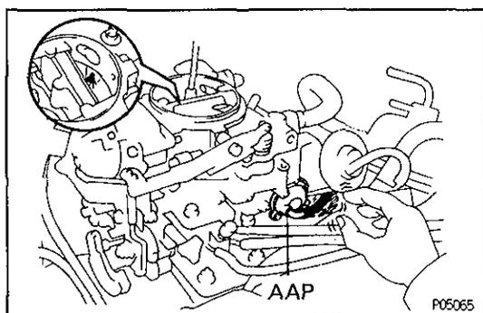
**7. INSPECT AUXILIARY ACCELERATION PUMP (AAP) SYSTEM**
