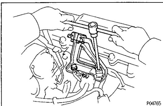
**20. INSTALL ACCELERATOR CABLE BRACKET**
