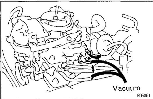
**12. INSPECT AUXILIARY ACCELERATION PUMP (AAP) DIAPHRAGM**
