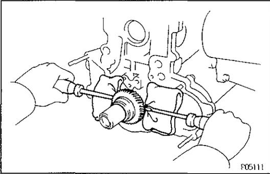
**15. REMOVE PUMP DRIVE SHAFT GEAR**
