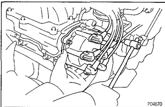
**11. REINSTALL DISTRIBUTOR CAP****12. RECONNECT DISTRIBUTOR CONNECTOR****IGNITER INSPECTION**
