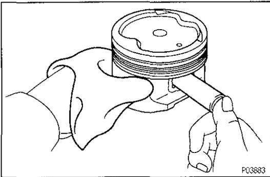
**D. Inspect piston pin fit**
