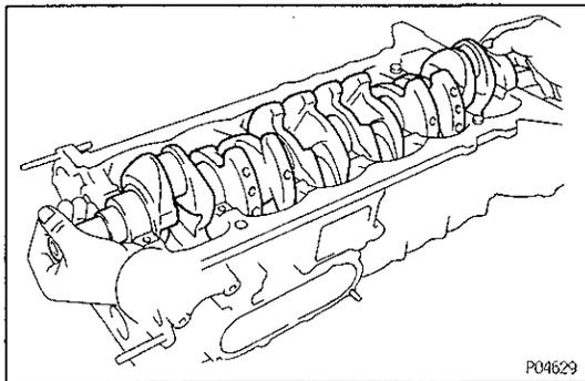
**5. PLACE CRANKSHAFT ON CYLINDER BLOCK**
