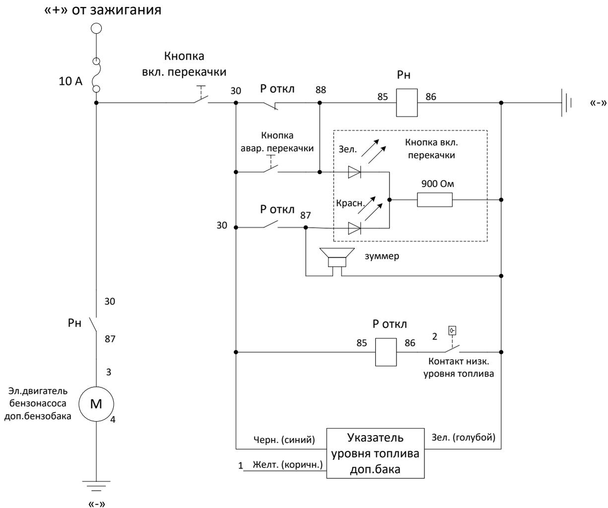
РН – реле насоса - 4 конт.реле
