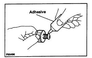
8. INSTALL OIL PRESSURE SENDER GAUGE
